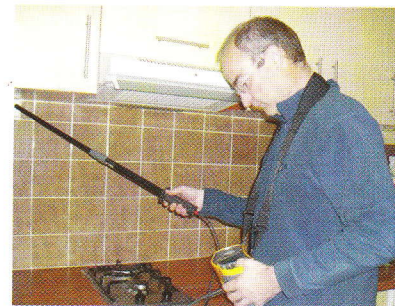
Mesure de continuité de terre pour un diagnostic de sécurité électrique (DSE).
